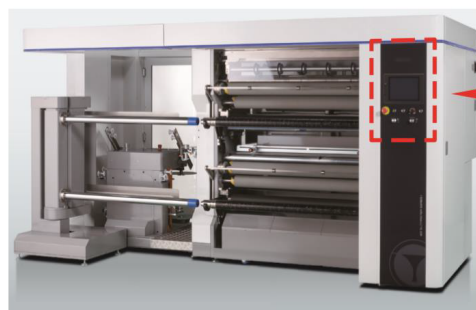
写真2 HMI (CMS: カメラモニターシステムとの切り換えが可能)
