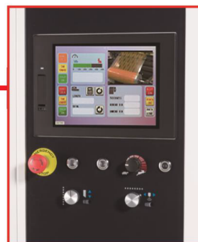
写真2 HMI (CMS: カメラモニターシステムとの切り換えが可能)
